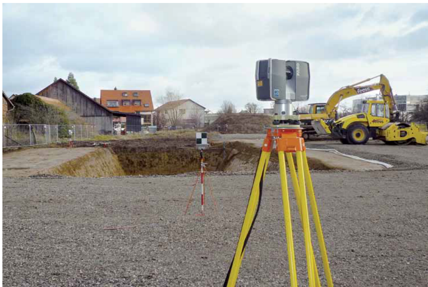
3D-laserscanner van FARO. De 3D-scangegevens zijn rechtstreeks compatibel met BIM-softwareoplossingen.
