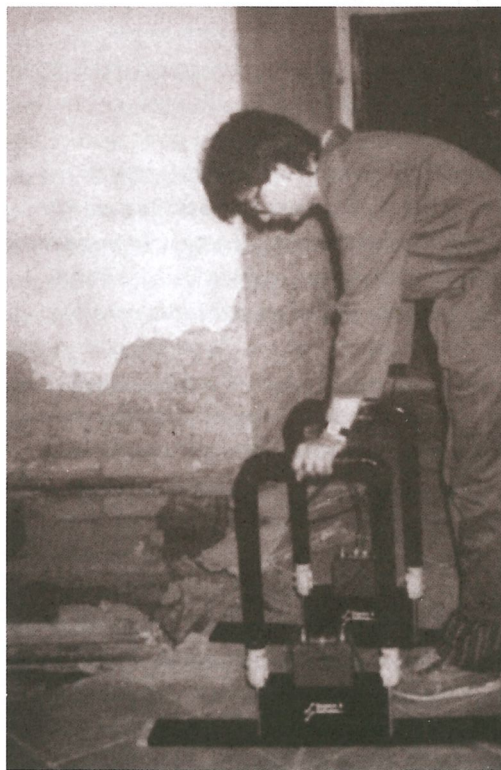
figuur 3 Radaronderzoek aan het fundament in het Franciscanen-klooster te Osijek, Kroatië
