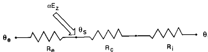
figuur 2. elektrisch analogon van een glasblad, waarop aan de buitenzijde een metaalfilmje is aangebracht. Hierdoor wordt een deel van het opvallende zonlicht geabsorbeerd ( \alpha E_z ), waardoor een verhoging van de temperatuur van het glasblad optreedt.
