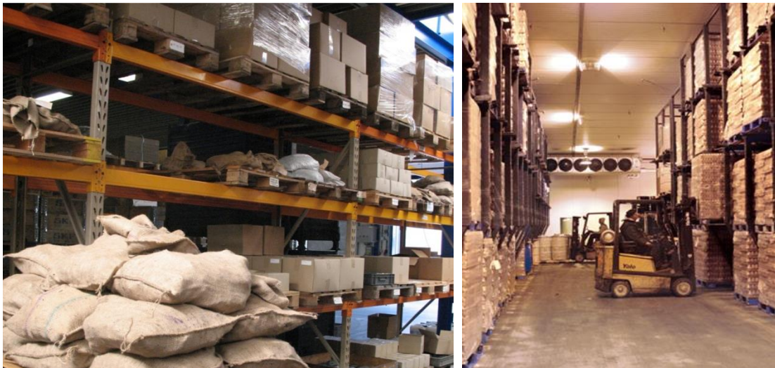
Figuur 2: Twee opslaghallen van ongeveer gelijke grootte en met eenzelfde vuurlast. In het ene geval vindt de opslag plaats bij omgevingstemperatuur (links: +20 °C), in het andere geval gaat het om een vriesveem (rechts: -20 °C).
