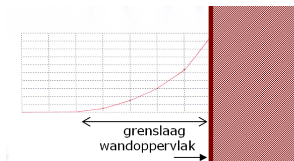
Figuur : temperatuurverloop in de grenslaag dichtbij het oppervlak. Omdat de langsstromende lucht wordt afgeremd door het oppervlak, verandert de warmteoverdracht door convectie. Daardoor ontstaat dit karakteristieke temperatuurverloop. NB de "grenslaag" is ongeveer een centimeter dik.
