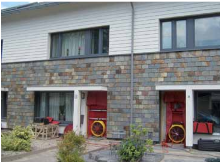
Het luchtdicht afwerken van de gebouwschil is precisiewerk. Het aantonen dat de vereiste luchtdichtheid is gerealiseerd is relatief eenvoudig mogelijk met een blowerdoortest.
