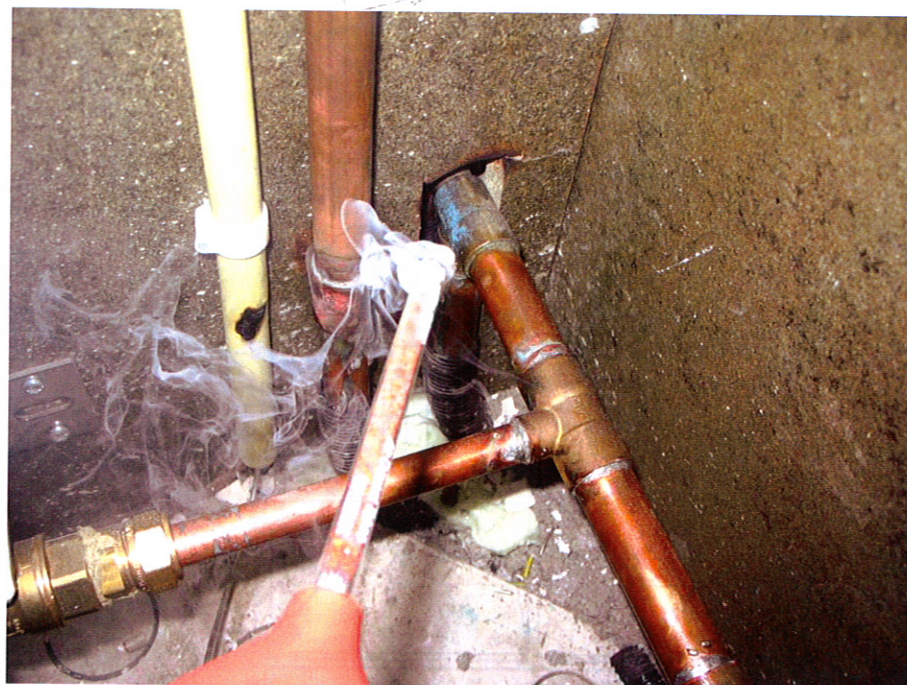
Naast een kwantitatieve bepaling van de luchtdichtheid wordt ook een kwalitatieve bepaling aanbevolen: waar zitten de luchtlekken? Foto: Adviesburo Nieman.
