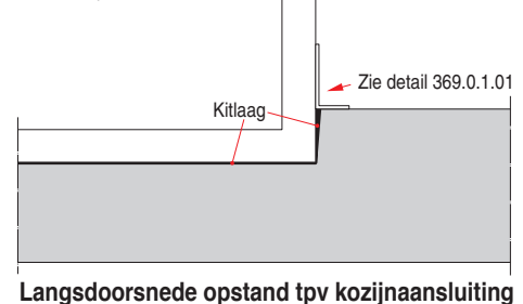
Kitlaag onder het kozijn en aan de zijkant tot aan de bovenzijde van de opstand.
