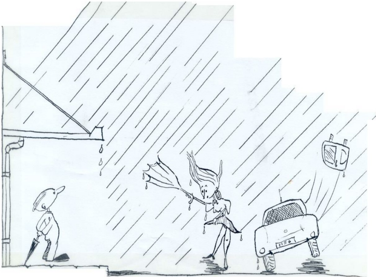
Figuur 32 Een luifel voor verbetering van het windklimaat is effectief bij verticale windstroming
