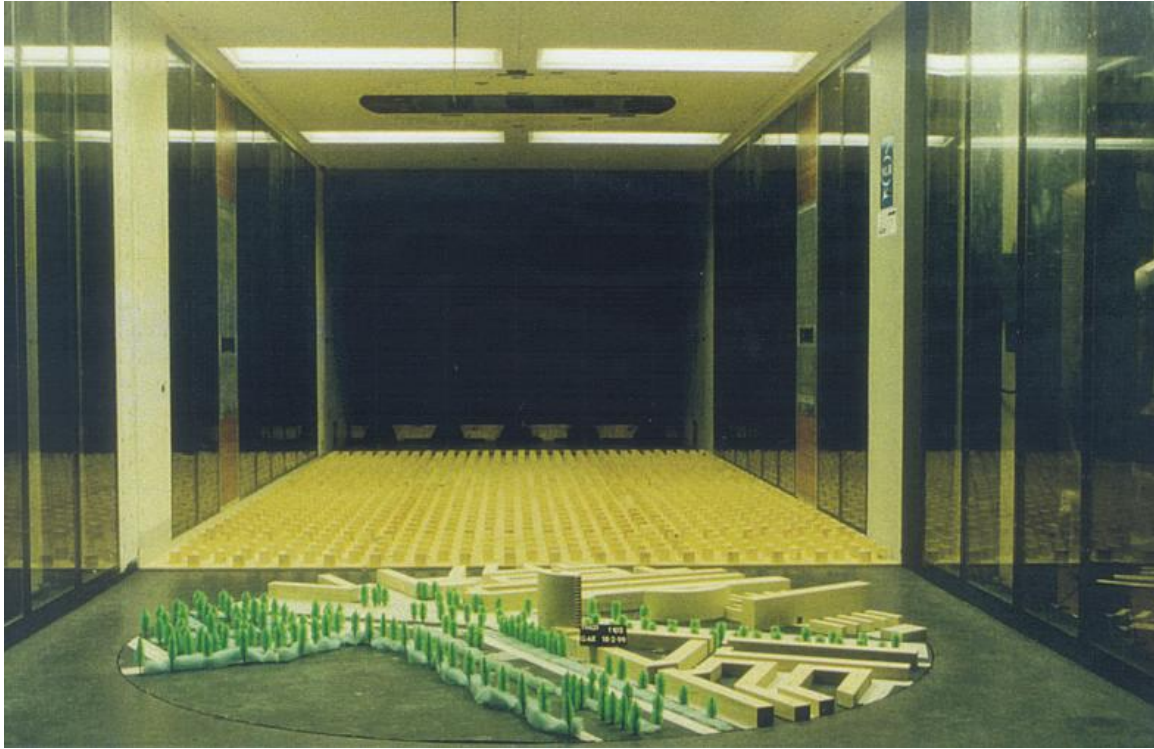
Figuur 27: Achter in de windtunnel zijn de 'haaievinnen' met daarachter de horizontale barrière zichtbaar. Voor in de tunnel de ruwheidselementen voor een stedelijke omgeving.
