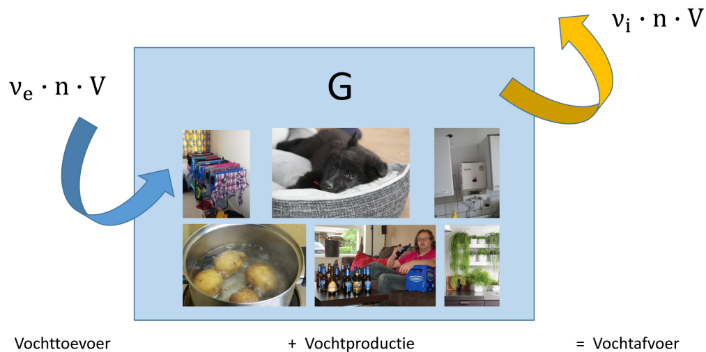
figuur 11-2 Principe vochtbalans
