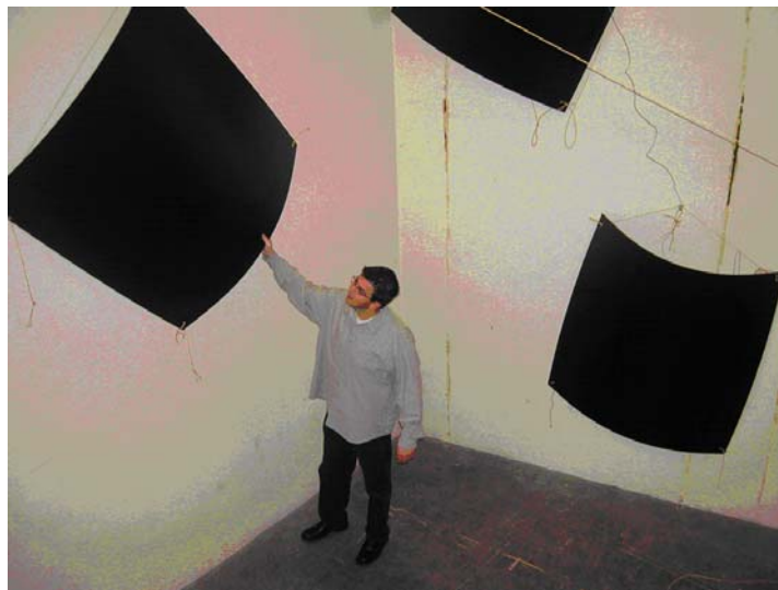
Figuur 4.3. Het interieur van een galkamer: een 'betonnen' ruimte van ca 200 m 3 met niet-evenwijdige vlakken en geluidverstrooiende elementen (diffusoren) voor een zeer goede geluidverdeling (diffuus geluidveld).
