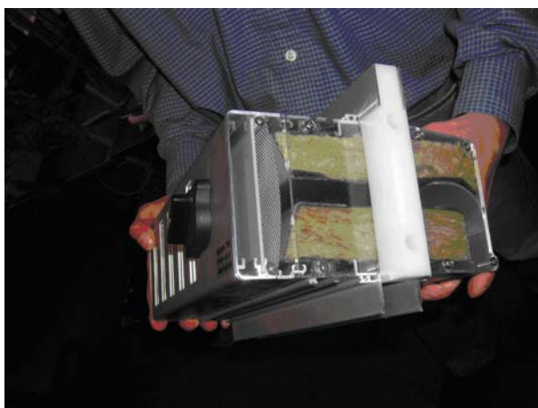
Figuur 4.22. Doorgezaagde suskast: natuurlijke ventilatie en geluidwering (mineraal-wolvulling!) in één.
