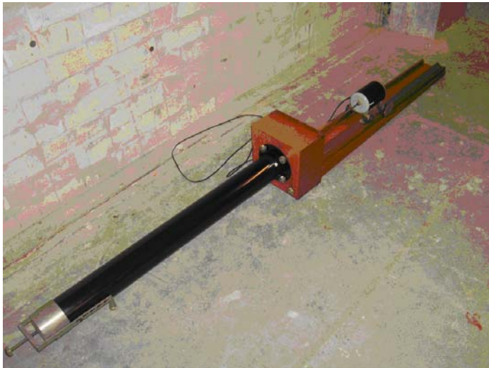
Figuur 4.2. Interferometer (Buis van Kundt) om de geluidabsorptie van poreuze materialen te bepalen.
