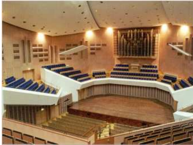
Figuur 1.15. De grote Concertzaal van het Muziekcentrum in Eindhoven (MCE) geeft vanaf elke positie in de zaal gegarandeerd vrij zicht op het podium door een oplopende vloer.
