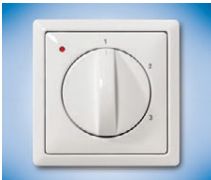
Afb. 6.1 Driestandenschakelaar van een gebalanceerd ventilatiesysteem met links een filterindicatielampje. Dit rode ledlampje gaat branden, wanneer de filters zijn vervuild. Het is een eenvoudige voorziening die er voor zorgt dat bewoners goed geïnformeerd worden en daardoor tijdig de filters zullen schoonmaken of vervangen. (Bron: Brink Climate Systems)
