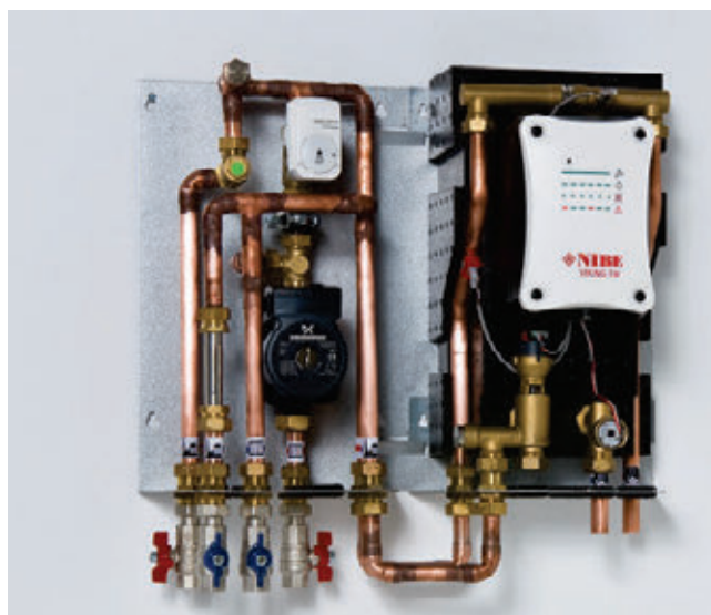
Afb. 7.35 Individuele afleverzet voor stadsverwarming met tapwaterverwarming via een platenwisselaar en warmtemeter. Let op de perfecte isolatie. Een compact apparaat heeft de voorkeur (Bron: NIBE Energietechniek)
