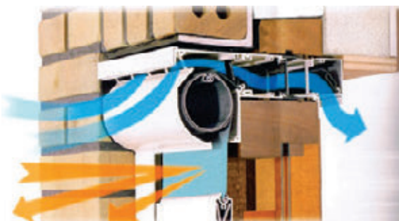
Afb. 4.12 Voorbeeld van een zonwerende screen geïntegreerd met een ventilatierooster (Bron: Duco)
