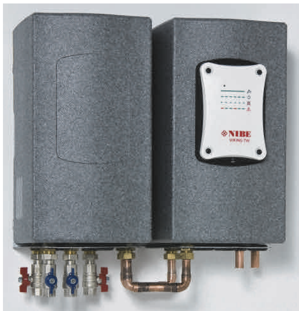
Afb. 7.35 Individuele afleverset voor stadsverwarming met tapwaterverwarming via een platenwisselaar en warmtemeter. Let op de perfecte isolatie. Een compact apparaat heeft de voorkeur (Bron: NIBE Energietechniek)
