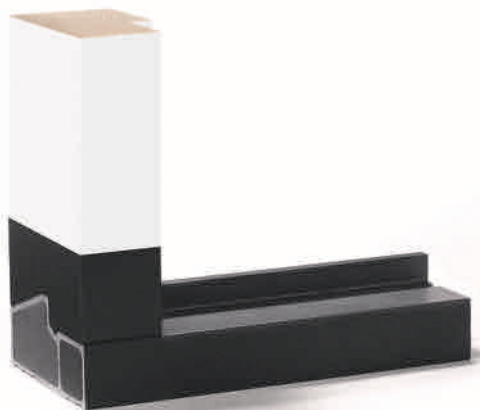
Afb. 5.28 Deze BUVA-ISOSTONE® onderdorpel van glasvezel versterkt kunststof is gevuld met PUR-schuim en heeft daardoor een gunstige U_{frame} -waarde van circa 0,9 à 1,0 W/(m 2 K) afhankelijk van het type dorpel; de versies voor hefschuifdeuren hebben een U_{frame} -waarde van 1,6 à 1,9 W/(m 2 K). (Bron: BUVA BV)
