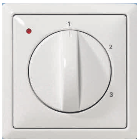
Afb. 6.1 Driestandenschakelaar van een gebalanceerd ventilatiesysteem met links een filterindicatielampje. Dit rode ledlampje gaat branden, wanneer de filters zijn vervuild. Het is een eenvoudige voorziening die er voor zorgt dat bewoners goed geïnformeerd worden en daardoor tijdig de filters zullen schoonmaken of vervangen. (Bron: Brink Climate Systems)
