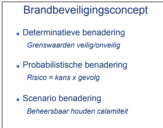
figuur 6. de drie benaderingen die in een brandbeveiligingsconcept een rol spelen; vooral de probabilistische benadering en de scenario-benadering spelen hierin een rol
