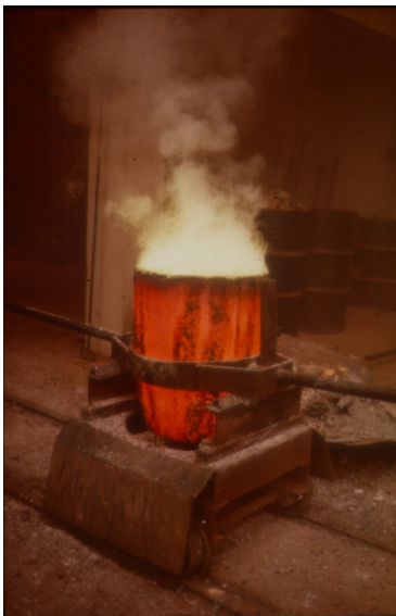
figuur 3. voorbeeld van een temperatuurstraler: pot gesmolten brons; de buitenkant van de pot heeft een lagere temperatuur dan het brons boven de pot
