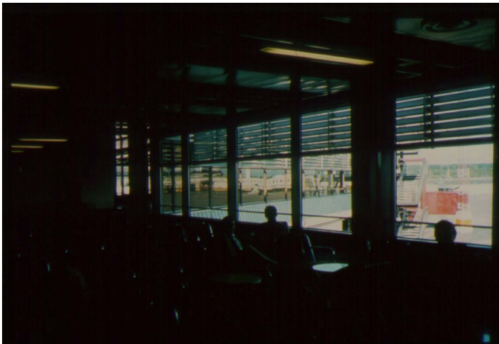
figuur 3. door de grote helderheid van het raam wordt het oog verblind en kunnen andere voorwerpen en mensen in de ruimte niet meer worden waargenomen; zelfs de aanvullende verlichting werkt in dit geval niet voldoende
