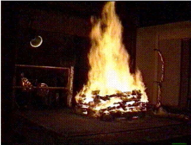
figuur 1. palletbrand in een grote ruimte; dit is een brandstofbeheerste brand
