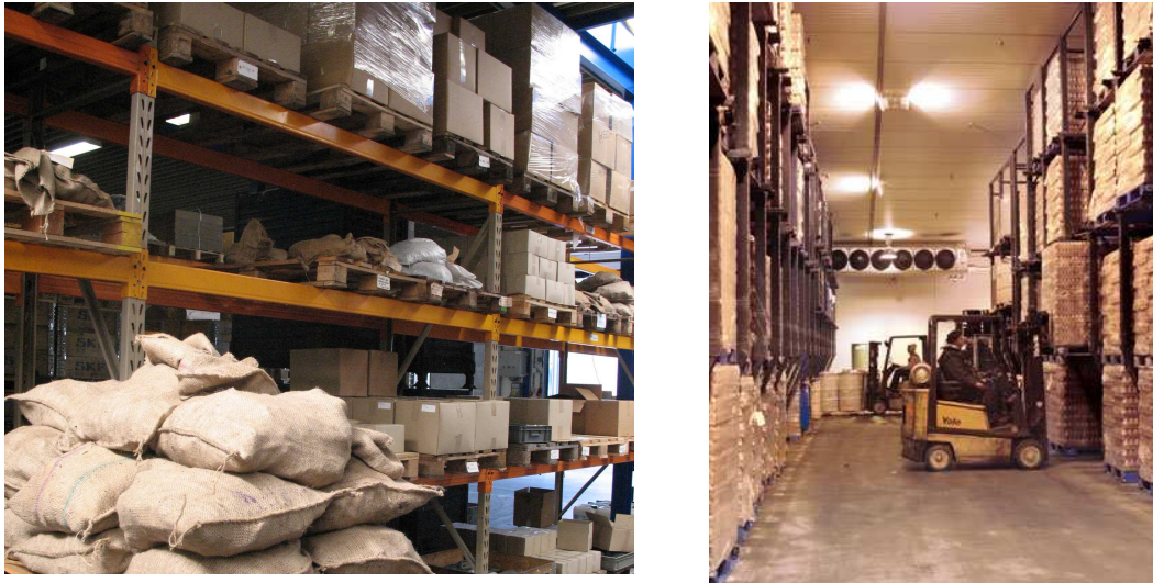
Figuur 1: Twee opslaghallen van ongeveer gelijke grootte en met eenzelfde vuurlast. In het ene geval vindt de opslag plaats bij omgevingstemperatuur (links: +20 °C), in het andere geval gaat het om een vriesveem (rechts: -20 °C).
